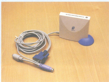
2 IC卡连接器。插口需要串行口和鼠标/键盘插口2种
