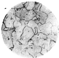
图 2—1 铁素体的显微组织
