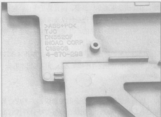
图1-2 腕托上盖为PC+ABS材料
