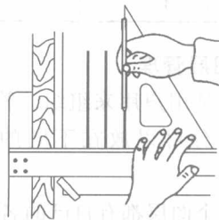
图 1-10 丁字尺、三角板配合画垂直线
