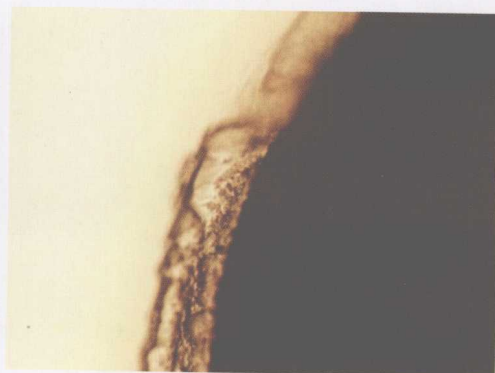
图 4-13 完整的粘结层（左）和收缩应力导致的粘结层断裂（右）
