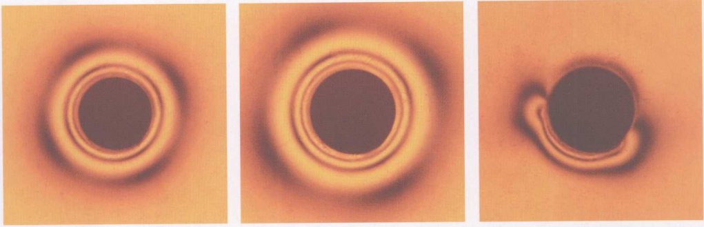
图 4-14 Charisma 树脂固化 1 小时、24 小时和 48 小时压应力条纹
