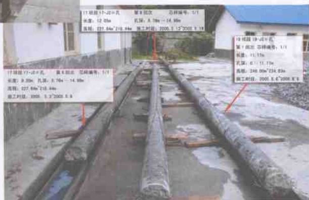
▲ 同一孔中连续取出的3根10m以上样芯
