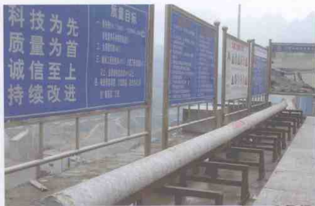
▲ 15.03m长的碾压混凝土样芯
