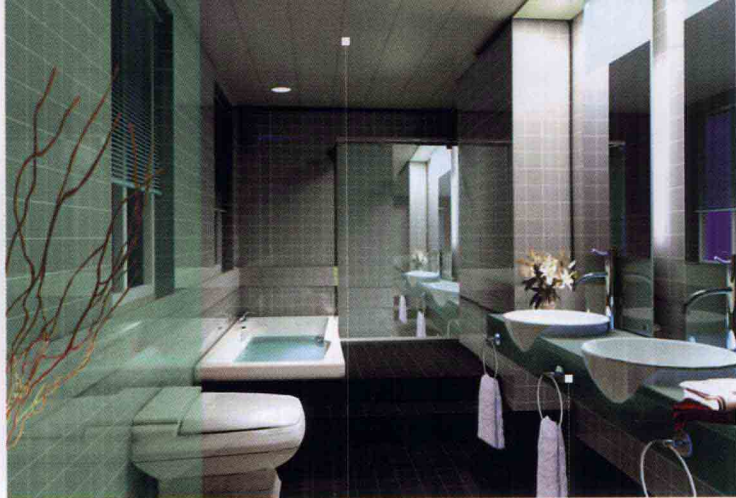
成品面盆——木丝水泥板——防火板——瓷砖——铝孔扣板吊顶——条形塑料扣板——12mm厚钢化玻璃——大理石墙面
