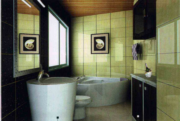
成品面盆——木丝水泥板——防火板——瓷砖——铝孔扣板吊顶——条形塑料扣板——12mm厚钢化玻璃——大理石墙面
