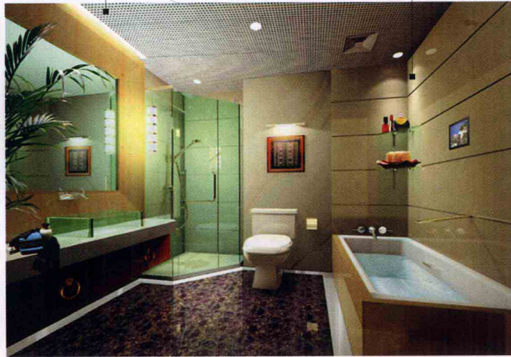
成品面盆——木丝水泥板——防火板——瓷砖——铝孔扣板吊顶——条形塑料扣板——12mm厚钢化玻璃——大理石墙面
