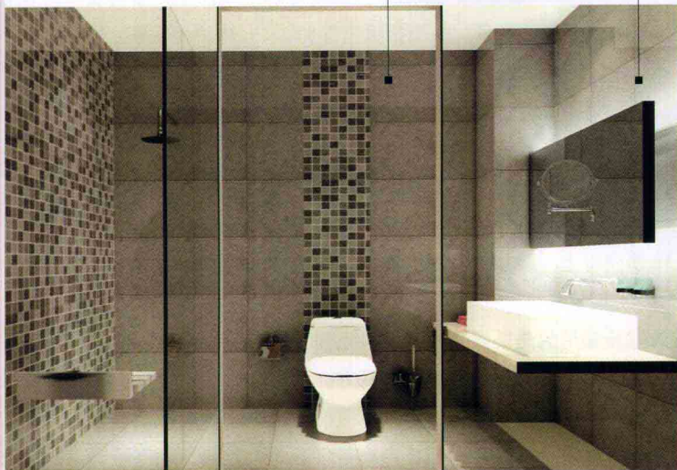
成品面盆——木丝水泥板——防火板——瓷砖——铝孔扣板吊顶——条形塑料扣板——12mm厚钢化玻璃——大理石墙面
