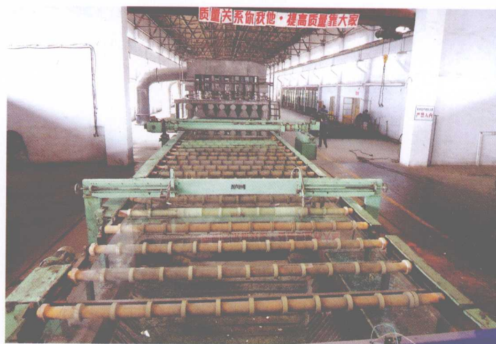
经过技改的日熔化量为550吨的浮法玻璃生产线
