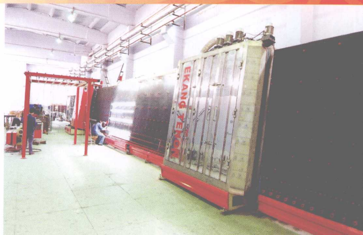
年产30万平米的中空玻璃生产线
