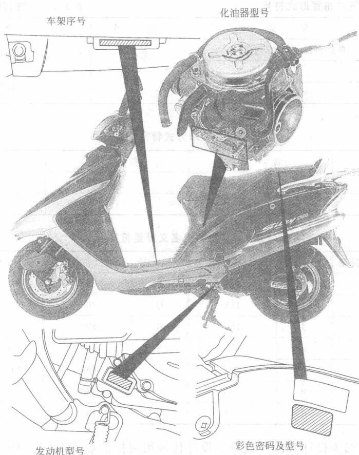
图 1-9 踏板车型上的型号或序号标注的部位
