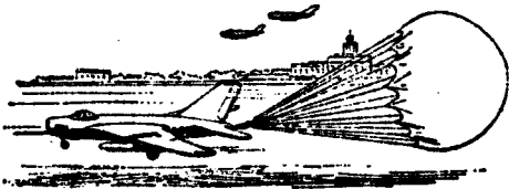
(a) 飞机为迅速着陆减速可用开伞增加阻力， 减少飞机的动惯性
