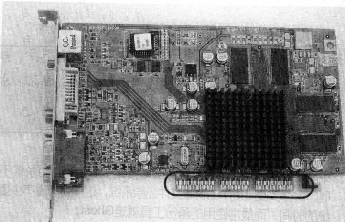
在主板上只安装CPU、内存、显卡和电源，然后试试能不能启动，
