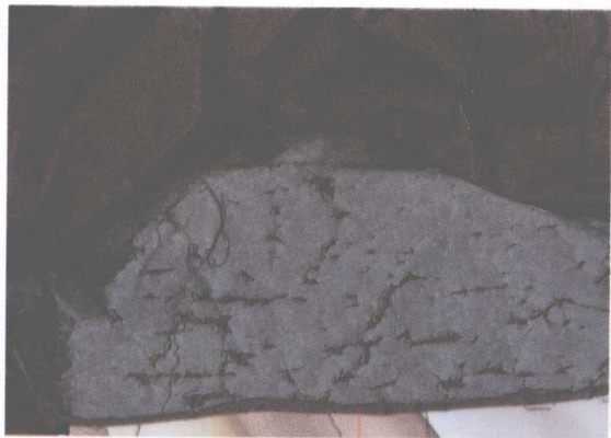
图1-3 干洗后面料内侧涂层破损（一）
