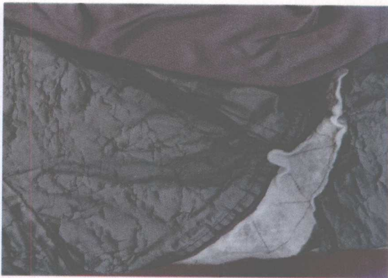
图1-4 干洗后面料内侧涂层破损（二）
