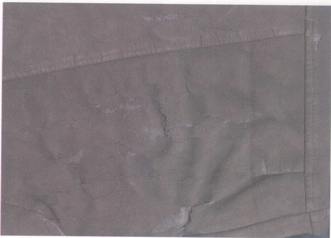
图1-2 静电植绒面料干洗破损
