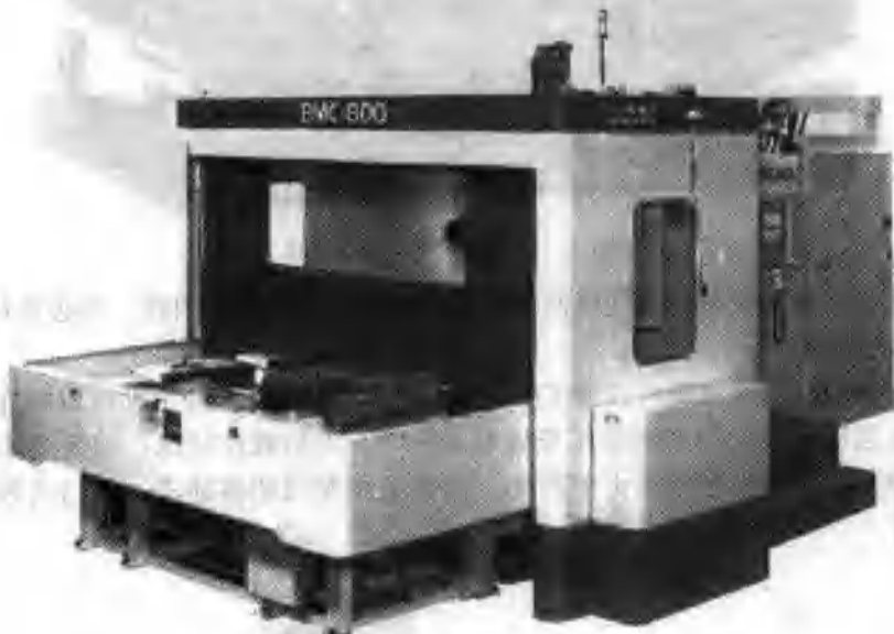
图1-1-4 数控卧式铣床或卧式镗铣类加工中心
