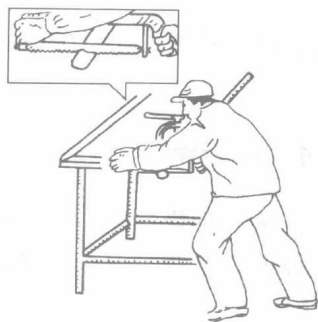
图 1-11 手工锯割管子操作
