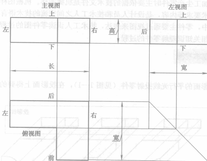
图 1—3 三视图的投影及方位关系
