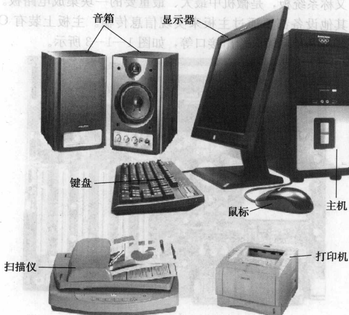
图 1—1—1 微型机的硬件组成
