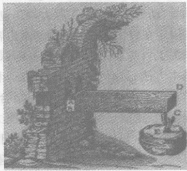
图 0-3 伽利略测量梁变形的实验
