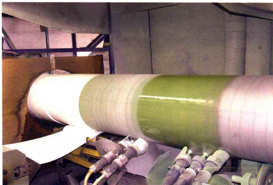
图 6 2205 双相不锈钢外防腐层工厂加工
