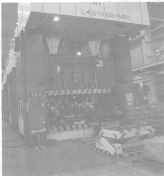
(e) 汽车车身钣金自动化成形设备
