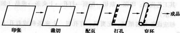
图 1-11 开闭环装订工艺流程图
