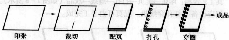
图 1-10 螺旋圈装订工艺流程图
