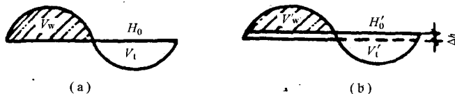
图 1-3 设计标高调整计算示意图
