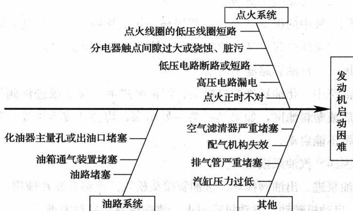
图 1—10 发动机启动困难的主要原因
