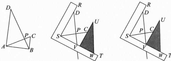
线,使  $PC = a$ ,  $PD = 2a$ ,然后在图形上放上木工用的直角拐尺,其内边为  $RST$ ,使得  $SR$  过点  $D$ ,并且直角顶  $S$  处于  $CP$  的延长线上. 让直角三角形  $UVW$  的直角边  $VW$  在  $ST$  上滑动,而直角边  $VU$  过  $C$  点. 最后调整两工具的位置,使  $V$  落在  $DP$  的延长线上<sup>①</sup>,  $PV$  就为之所求.
