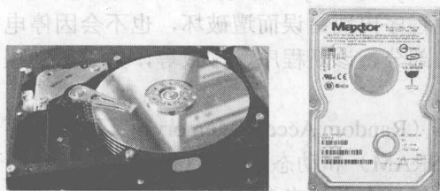
图 1-6 硬盘内部结构及外观
