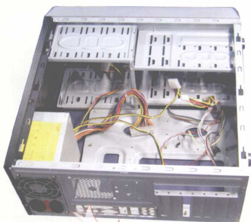
安装主板 I/O 接口挡板
