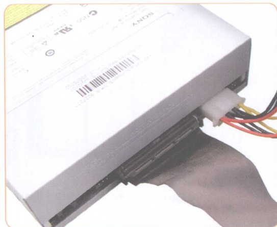
将插头插入光驱电源接口
