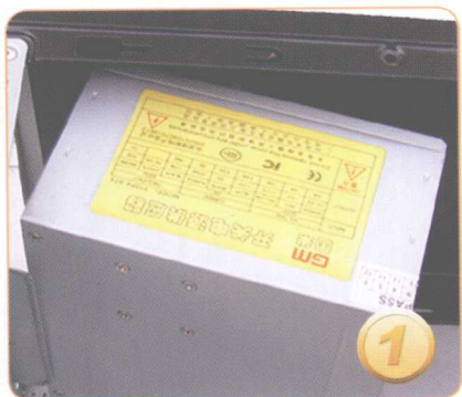
将电源放入机箱中的电源位
