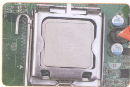
将拉杆卡入CPU插座
