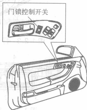
图 1.2.1 门锁控制开关的位置
