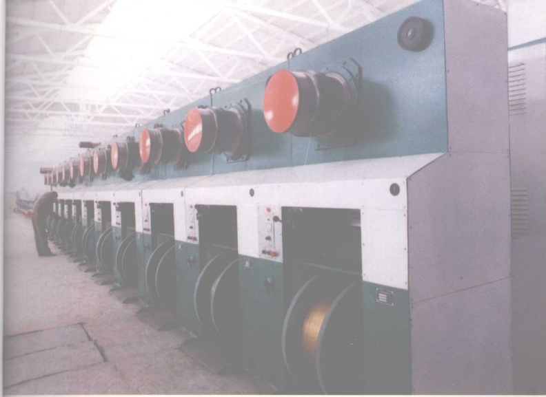
钢帘线车间电镀生产线一角
