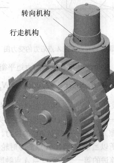
图3 新型轮爪式越障轮的三维模型图
