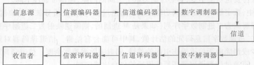
图 1.2-2 数字通信系统(数字调制系统)的基本组成框图
