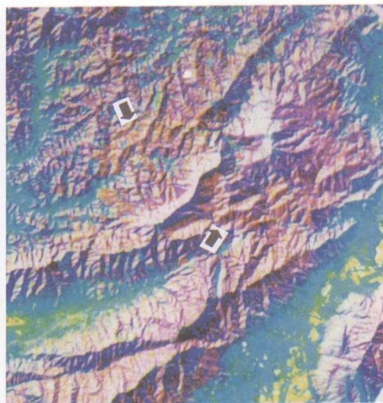
彩图8 广东鼎湖斑岩钼矿区TM卫片中的 TM_5 、 TM_4 和 TM_2/TM_3 主成分分析假彩图，箭头指处为生物地球化学效应异常
