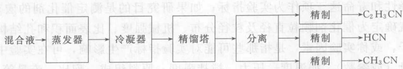
图 1.2 丙烯腈与副产物分离的工艺流程(一)
