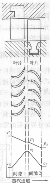
图 1-4 反动级示意图
