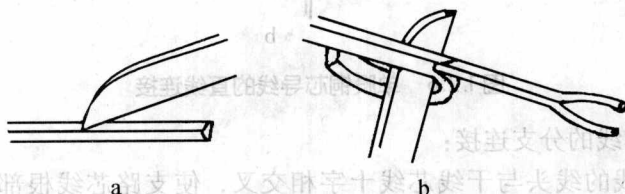
图 1.2.4 塑料护套线绝缘层的剖削
