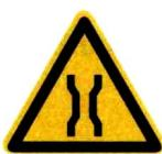
图示是警告标志,警告驾驶员注意前方桥面宽度变窄,应减速慢行,严禁超车,谨慎驾驶。
