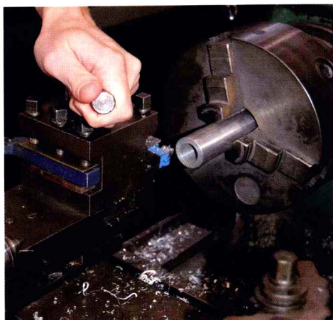
2 需要切割的管材被夹具夹紧。切刀正悬起，准备进行切削。
