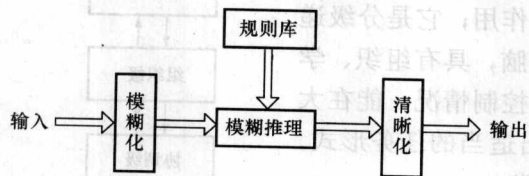
图 1-6 模糊控制单元基本功能结构图
