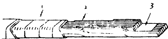
1、卷装绝缘 2、聚乙烯醇缩甲醛电线 3、绝缘纸
