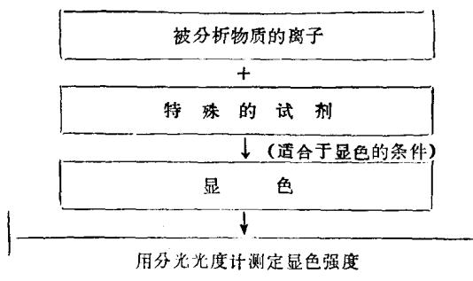
为了使分光光度法更精确，首先要正确地选择与被分析物的离子能进行显色反应的显色剂。其颜色强度必须与被分析物的浓度成正比。除此以外，还有一个重要的条件：正确地操作分光光度计，进行颜色强度的测定。
