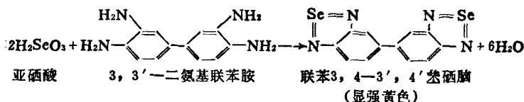
即，二个亚硒酸分子与一个3,3'-一二氨基联苯胺分子进行反应，生成一个显强黄色的联苯3,4-3',4'二苯硒脑分子和六个水分子。由于二个亚硒酸分子能生成一个联苯3,4-3',4'二苯硒脑分子，所以随着试样中硒含量的增加，产生的联苯3,4-3',4'二苯硒脑分子也成比例增加，使溶液的颜色强度也有规律地增强。我们只要测定显色的强度，就可以定量分析出硒的含量。
