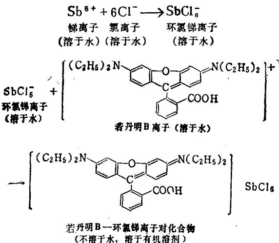
首先，锑离子与氯离子反应，生成环氯锑离子。然后，一价的环氯锑阴离子与一价的若丹明 B 阳离子反应，生成若丹明 B 一环氯锑离子对化合物。由于该化合物能被有机溶剂萃取，所以可以使有机溶剂呈紫色。
