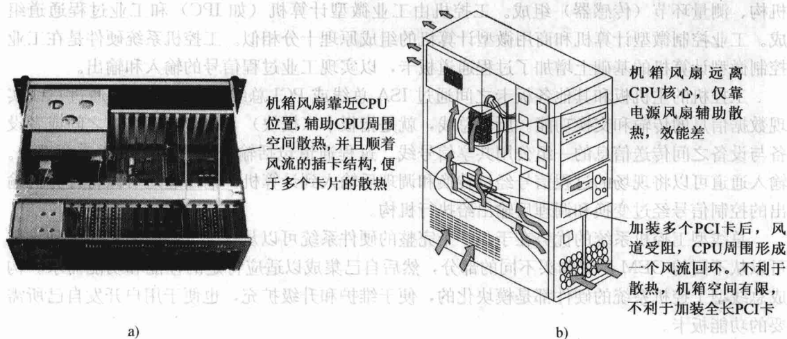
图 1—4 机箱的散热设计
