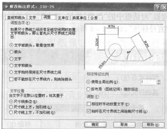
图 1-5 基础样式“调整”选项卡设置
