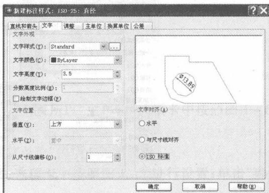
图 1-9 直径标注子样式“文字”选项卡设置
