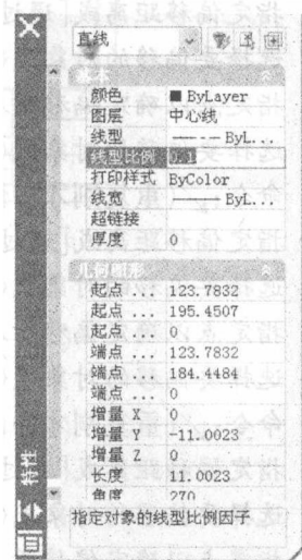
图 1-15 调整中心线线型比例
