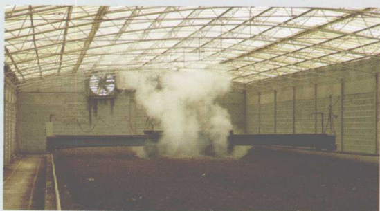
宁波环瀛科技有限公司研发的多槽式改单槽式液压滚筒翻堆机
