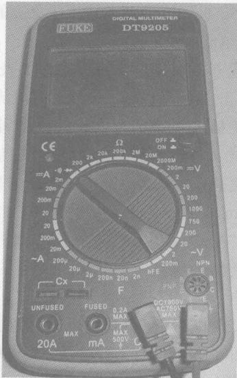
尤其需要注意的是：不能用测电阻、电流的挡位去测电压。如果用测直流电流或电阻的挡位去测量交流 220V 的电源电压，万用表立刻就会被烧毁。
