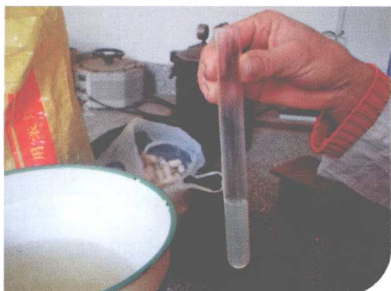
图 2-7 每支试管装液量约 10 毫升
