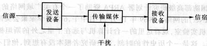
图 1-1 通信系统概念模型
