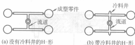
图 1-23 两种 H-形流道系统
