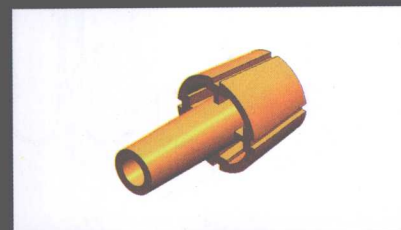
实例3-8 旋钮（练习轴对称收缩的方式设置模具的收缩率）
