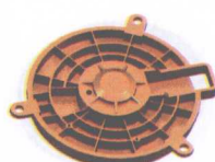
实例6-6 轴流盘 (使用自动孔补片的自动环选择方法对轴流盘表面进行补片操作)
