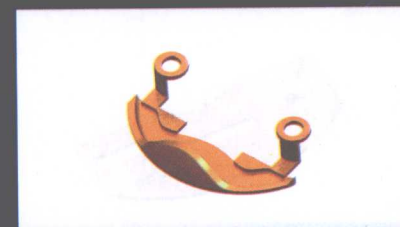
实例5-11 鼠标嵌件 (综合练习分型面的设计方法)
