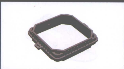
实例7-7 电池盖 (练习使用修剪实体工具修补破孔的方法)
