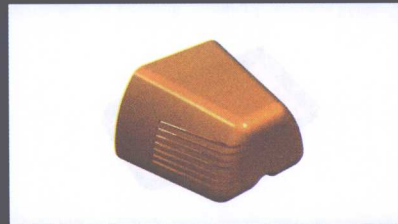
实例7-3 漏桶（练习将扩展曲面作为分型面的方法）
