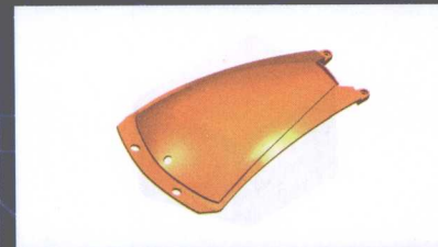
实例4-5 玩具车前窗(练习创建转换对象对分型线编辑的方法)
