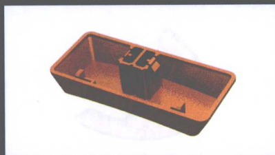
实例3-19 键盘按键(练习Mold Wizard中装载“家族”注塑产品的方法)
