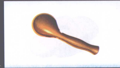
实例5-9 油箱盖 (练习缝合分型面的方法)
