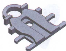
实例3-13 底座(练习创建一腔两模的矩形布局方法)
