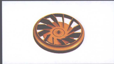
实例7-2 叶轮盘（练习将现有曲面加为破孔修补面的使用方法）
