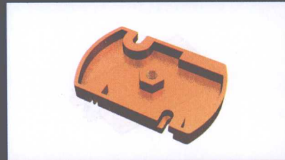
实例8-8 燃气灶旋钮 (练习布局中有多个型腔的分型方法)
