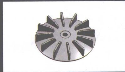
实例3-7 叶轮（练习均匀收缩的方式设置模具的收缩率）
