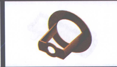
第6章 模具工具——修补破孔 实例6-1 瓶盖固定架 (练习使用边界区域方式提取型芯型腔的方法)
