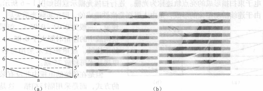
图 1-8 奇偶合成光栅示意图 (a) 和图像合成示意图 (b)
