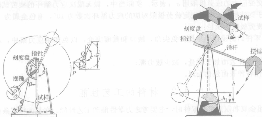
图 1-7 摆锤式冲击试验机示意图
