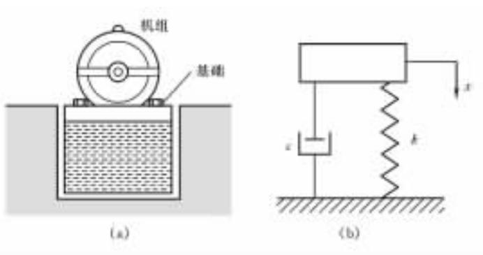
图 1-3 机组及其单自由度系统的动力学模型
