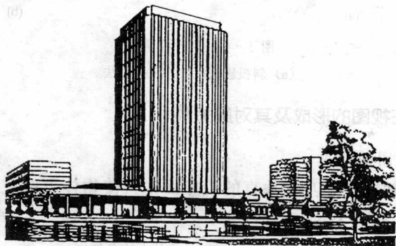
图 1-3 用中心投影法绘制的图样
